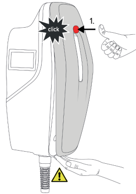
Afb. 19: Frontcover aanbrengen (voorbeeld) - 1
